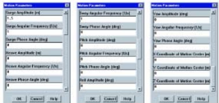
ユーザー定義サブルーチンにより、ユーザーは 6 自由度の動きを簡単に入力できる
