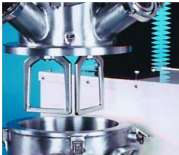
DPM-2ガロン2重プラネタリーミキサー 資料提供: Charles Ross & Son Company
