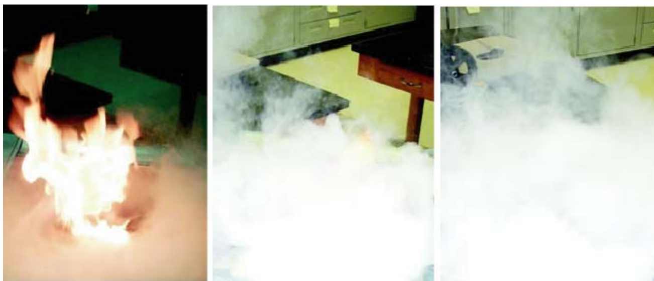
NanoMist による局所的フラッシング実験で火元周辺の噴霧が火元に引き込まれ、ヘプタン溜まりの火災を鎮火する様子
