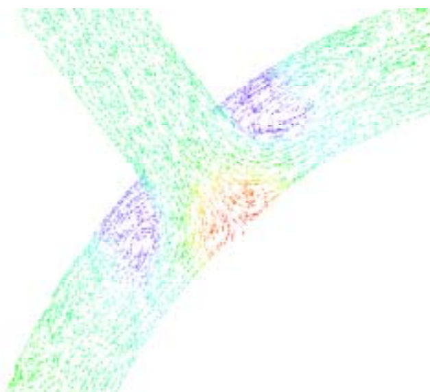
スパージャー内部のガスの流れ
