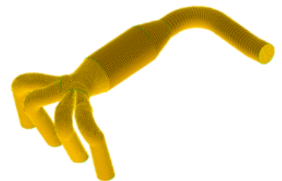
図 2: シミュレーション用のサーフェスマッシュ
